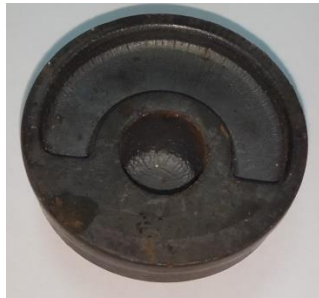
Рисунок 1. Заготовки зубчатых колес, производимые методом порошковой металлургии на АО «Завод «Фиолент».
