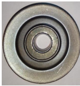
Рисунок 1. Заготовки зубчатых колес, производимые методом порошковой металлургии на АО «Завод «Фиолент».
