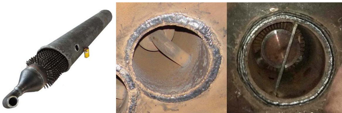
а) ошипованный элемент в дымогарной трубе б) вид из топки на крепление элемента в) вид выходной газовой камеры на элемент Рисунок С.4 – Общий вид ошипованного элемента
