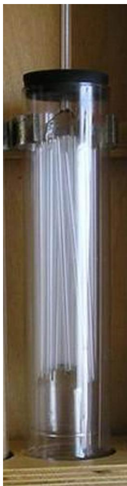
Рисунок 4.2 – Поглотительный сосуд: 1 – стакан; 2 – колокол; 3 – колпачок; 4 – тонкостенные стеклянные трубки (45 шт.); 5 – пробка; 6 – трубка; 7 – силиконовая трубка
