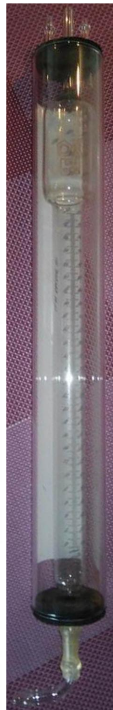
Рисунок 4.3 – Измерительная бюретка: 1 – бюретка; 2 – цилиндр; 3, 7 – пробка; 4 – стеклянные трубки; 5 – отвод; 6 – силиконовая трубка
