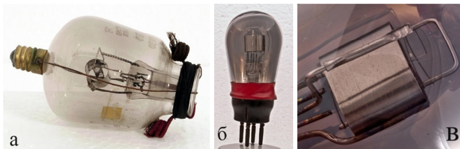
Рис. 4. Версии лампового триода производства Osram : а — тип R5 , б — тип R5V , в — анод и пружина, удерживающая верхнюю часть перевернутой V -образной нити в лампе R5V .
