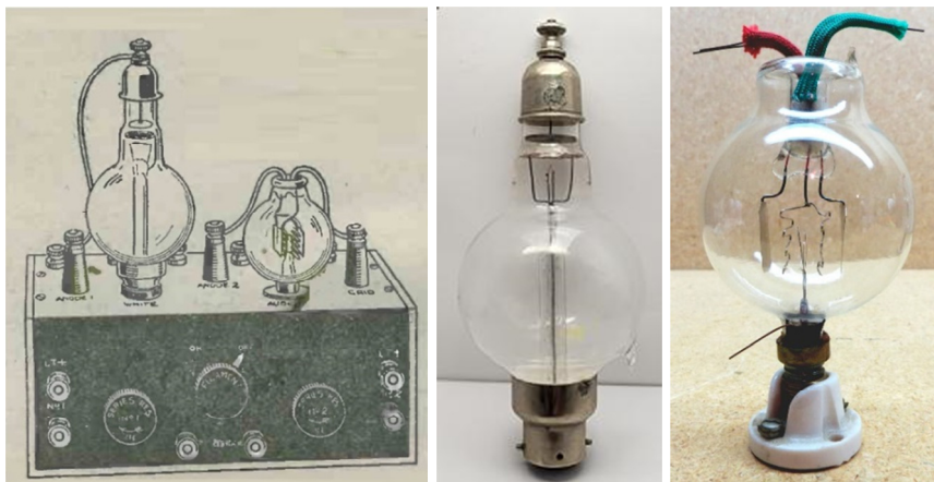
Рис. 2. Усилитель радиочастоты Mark III . 1917 г. Общий вид ламповых триодов, установленных в усилителе РЧ: триод типа White и DeForest Audion .
