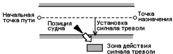
Рисунок 6.4 – Условие срабатывания сигнала тревоги “XTE alarm”
