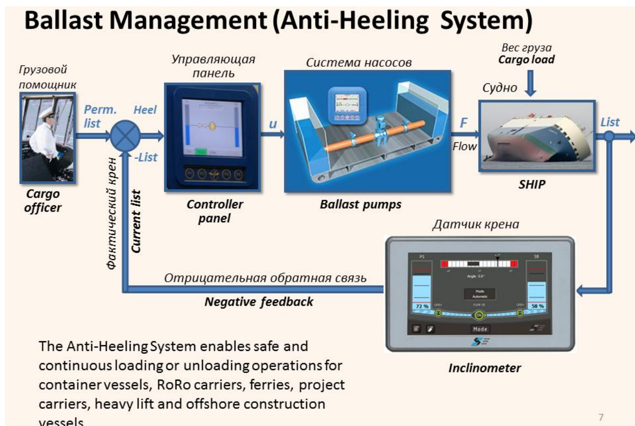
Рисунок 3.4 – Структурная схема САР крена судна
