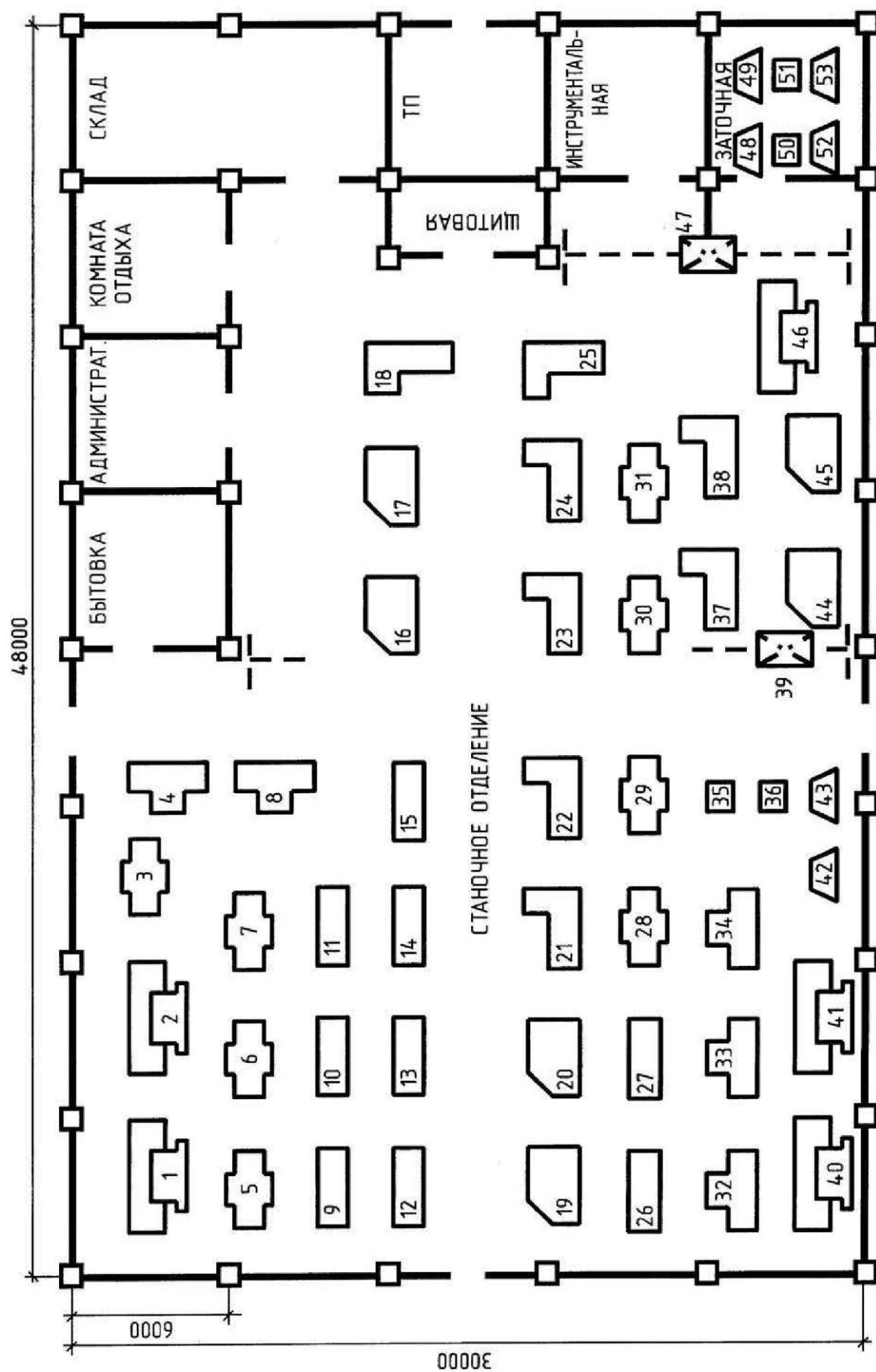
Рис. 11.3 - План расположения электрооборудования инструментального цеха
