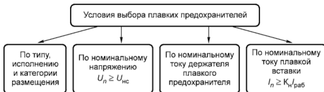
Рис. 9.10 - Основные условия, по которым выбираются предохранители
