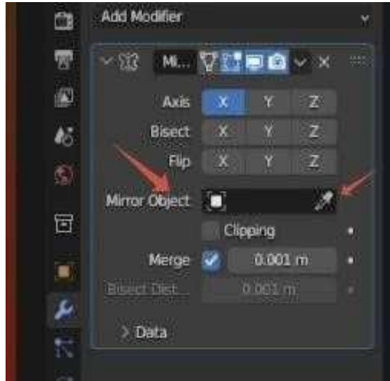
Рисунок 6.11 – Настройки параметров модификатора Mirror
