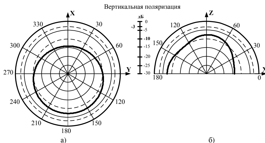
Рисунок 4 — ДН логопериодической антенны в плоскости XOY — а) и YOZ — б)
