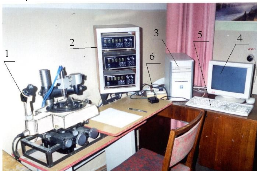
Рисунок 4 - Стенд метрологической аттестации преобразователя положения вектора ППВ-3И
