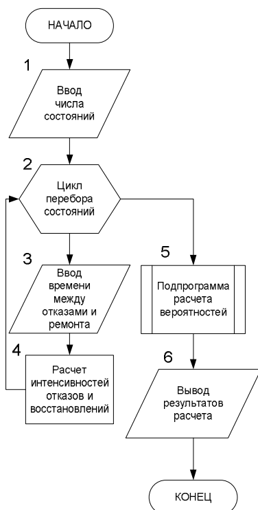
Рисунок 4 – Блок-схема алгоритма расчета финальных вероятностей состояний электроинструмента с учетом отказов элементов системы
