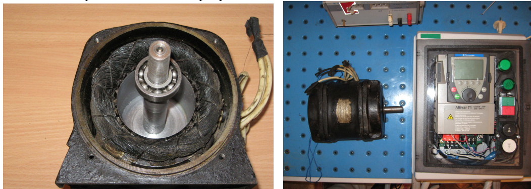
Рисунок 5 – Использование статора трехфазного асинхронного двигателя
