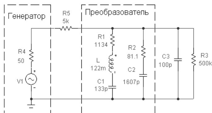
Рисунок 4 – Модель схемы пьезоэлектрического преобразователя
