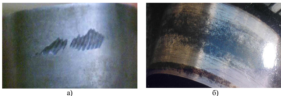
Рисунок 1– Дефекты, возникающие на рабочих поверхностях распределительного вала: а – на финишных операциях; б – в процессе эксплуатации
