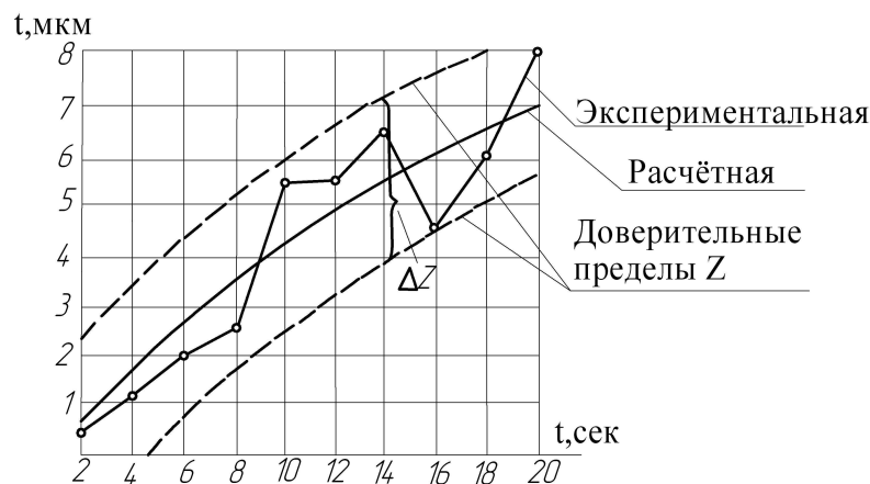
Рисунок 2 – Интенсивность съема материала при притирке
