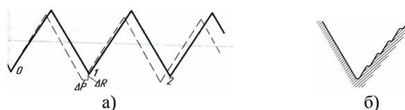
Рисунок 2 – Схема образования искажения профиля
