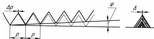
Рисунок 3 – Схема образования профиля резьбы метчика со смещением вершины
