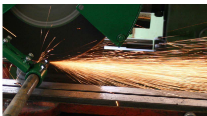
Рисунок 1 – Процесс резания заготовки абразивным отрезным кругом
