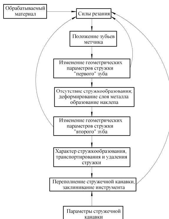
Рисунок 7 – Схема взаимосвязи элементов процесса резьбонарезания при наличии скругления на режущей кромке зуба
