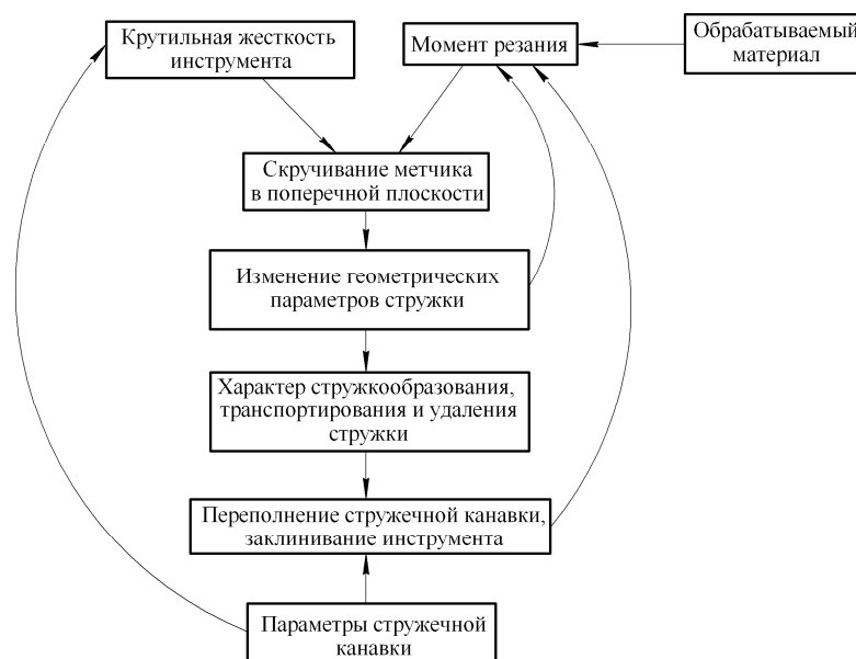
Рисунок 8 – Схема взаимосвязи элементов процесса резбонарезания при скручивании метчика
