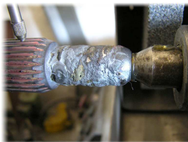
Рисунок 4 – Наплавленная шейка подшипника первичного вала
