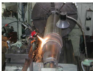
Рисунок 3 – Схема плазменной наплавки
