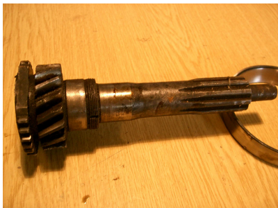
Рисунок 2 – Первичный вал коробки перемены передач автомобиля
