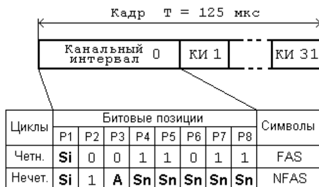
Рисунок 2.3 — Структура служебного нулевого кадрового интервала
