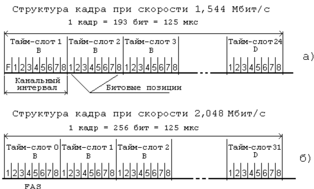
Рисунок 2.2 — Структура кадров первичного цифрового потока
