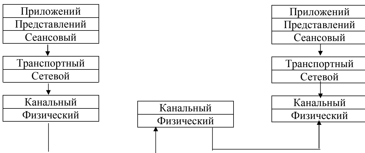
Рисунок 1- Схема движения информации по уровням модели при коммутации кадров
