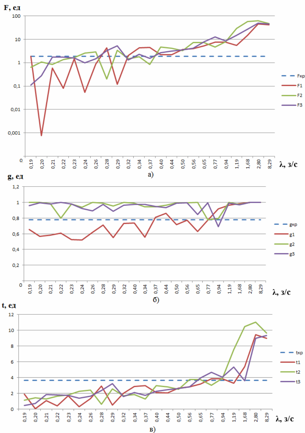
Рисунок 3 — График зависимости параметрических критериев, от интенсивности входного потока атак на узел КС для трех экспериментов: а) критерий Фишера; б) критерий Кокрена; в) критерий Стьюдента
