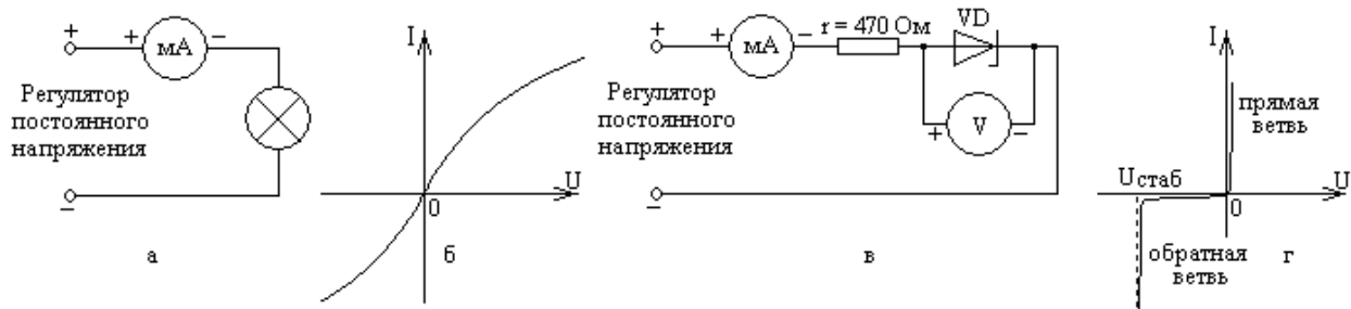
Рисунок 3 – Схема получения ВАХ лампы а) и стабилитрона в); ВАХ лампы б) и стабилитрона г)
