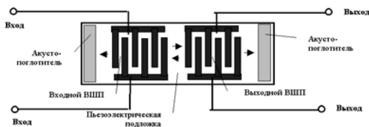
Рис.1. Конструкция фильтра на ПАВ.
