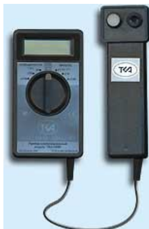
Рисунок 1 – Прибор комбинированный ТКА-ПКМ с фотометрической головкой (№ 24248-04 в Госреестре средств измерений)
