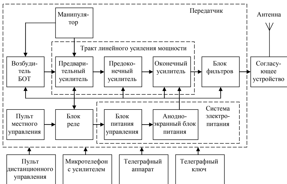
Рис. 1.1 — Структурная схема радиопередающего устройства «Корвет» («Бриг»)
