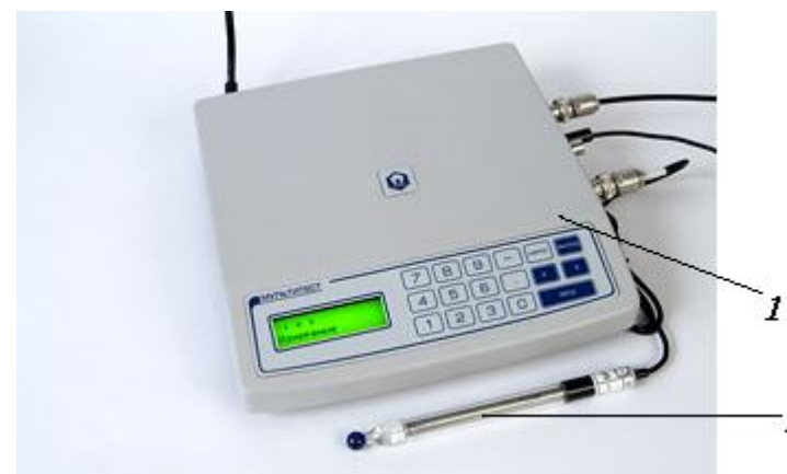
Рисунок 3 - pH-метр / иономер Мультитест ИПЛ-113 - (1). Предназначение: измерение активности ионов водорода (pH), концентрации ионов любой валентности, окислительно-восстановительного потенциала, а также температуры водных растворов. Электрод – (2)
