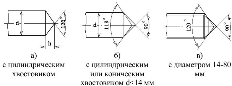
Рисунок 2.1 – Размеры наружных центров для сверл и припуски на затачивание.
