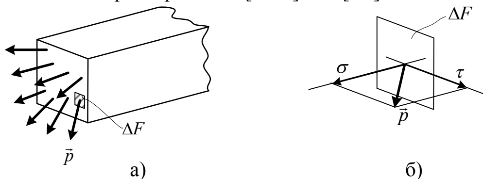
Рисунок 1 Напряжения в поперечном сечении стержня
