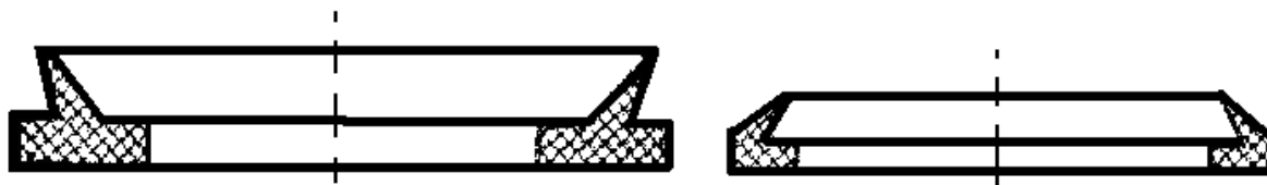
Рисунок 2 - Кольцевые вакуумные уплотнения
