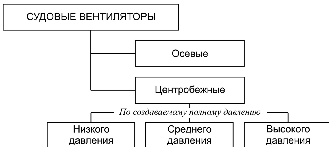
Рисунок 2.7 – Классификация судовых вентиляторов
