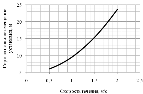
Рисунок 3 – График зависимости горизонтального смещения установки от скорости течения
