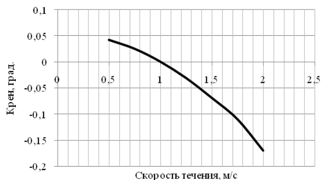
Рисунок 5 – График зависимости углового смещения установки от скорости течения
