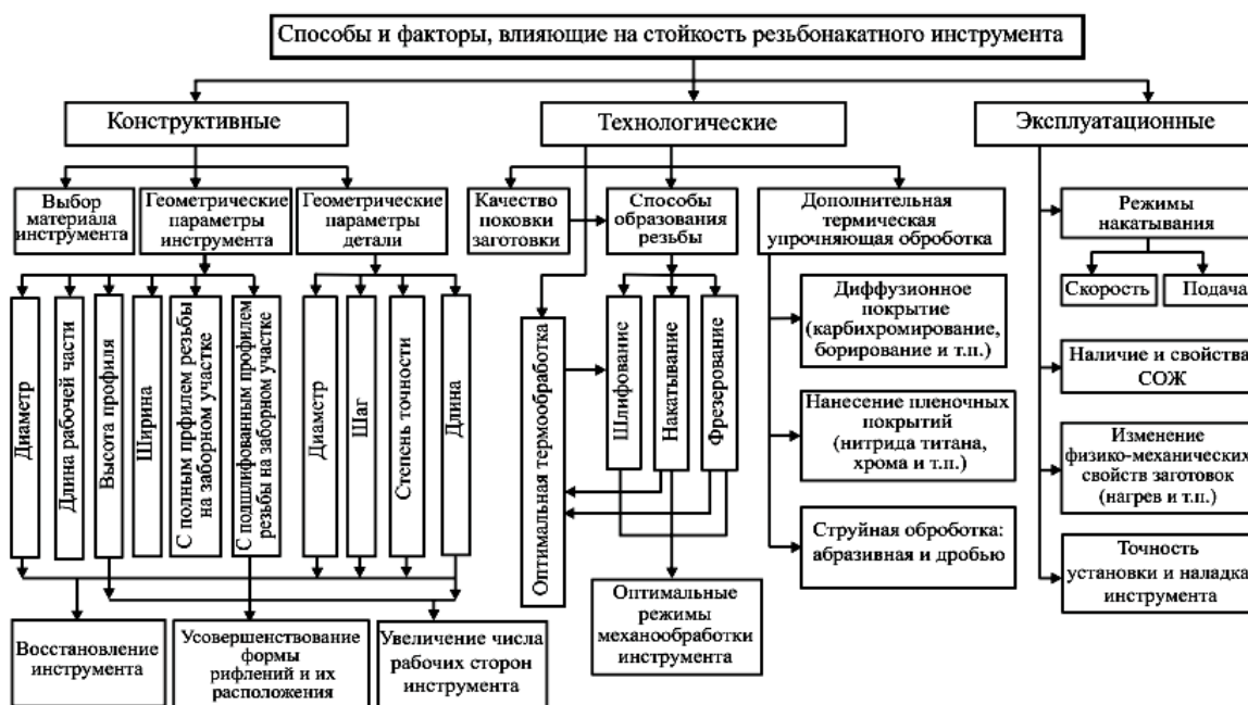
Рисунок 4 – Классификация различных способов увеличения срока службы резбонакатного инструмента
