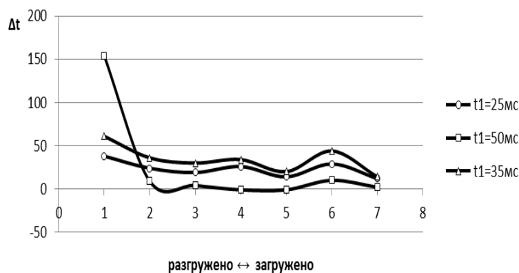
Рисунок 6 – Зависимость времени срабатывания от положения регулятора или загрузки автомобиля
