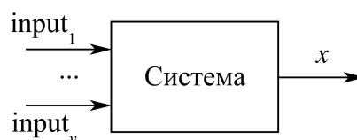
Рисунок 1 – Система типа чёрного ящика
