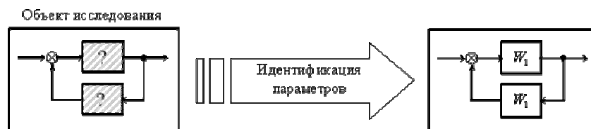
Рисунок 2 – Принцип идентификации типа «серый ящик»
