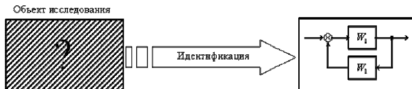
Рисунок 1 – Принцип идентификации типа «чёрный ящик»
