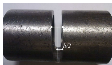
Рисунок 2 – Схема изменения паза под воздействием температурных деформаций
