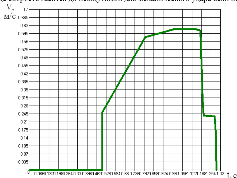
Рисунок 3 – График изменения скорости движения поршня во времени на полном участке движения
