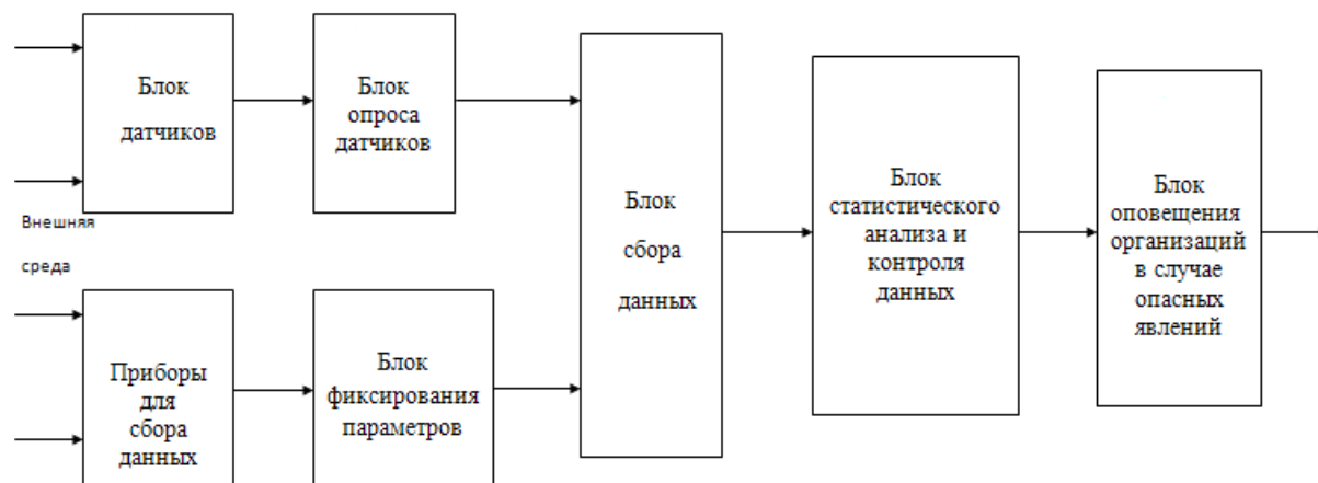
Рисунок 2 — Система экомониторинга (СЭМ) с минимальной обязательной функциональностью F_{\min}
