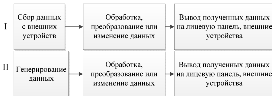
Рисунок 4 — Варианты блок схем измерительного оборудования
