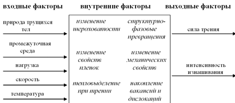
Рисунок 5 – Схема факторов, влияющих на фрикционное взаимодействие твердых тел
