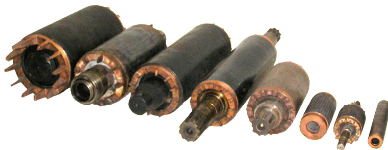
Рисунок 1 – Сердечники роторов с литой медной обмоткой взрывозащищенных асинхронных двигателей
