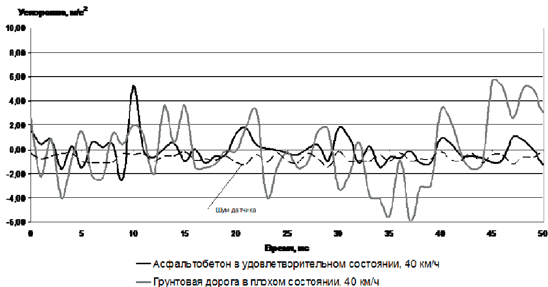
Рисунок 2 – Ускорения колебаний кузова автомобиля на различных дорожных покрытиях
