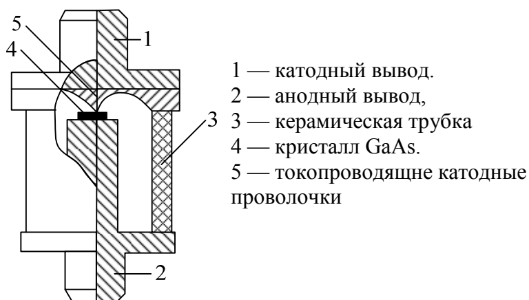
Рис. 5.8 — Конструкция диода Ганна
