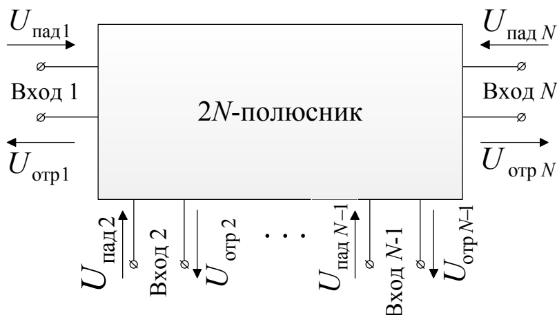
Рис. 3.2 — Эквивалентная схема 2N -полюсника
