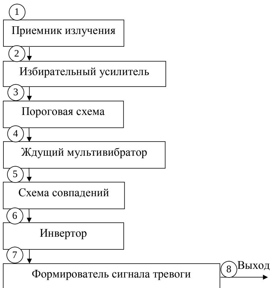
Рис. 1.3 — Функциональная схема извещателя
