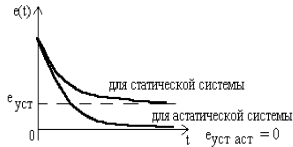
Рис. 2.13 — К определению характера статической ошибки
