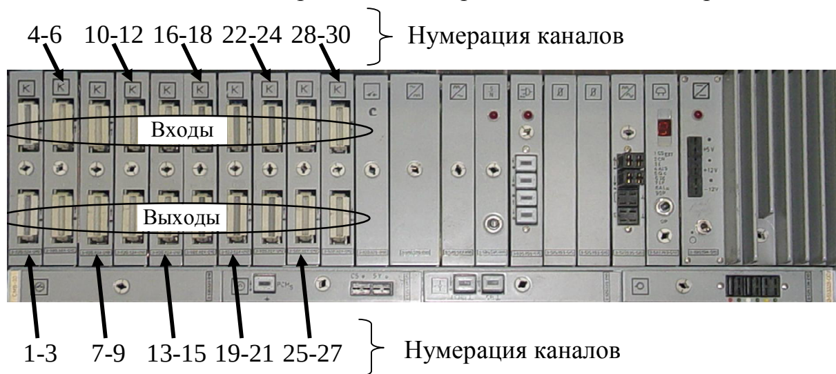
Рис. 1.5 — Схема расположения разъемов на передней панели БЧПКПР
