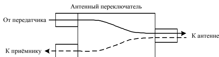
Рисунок 6.3 — Принцип работы антенного переключателя
