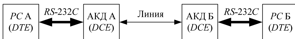
Рисунок 1 — Полная схема соединения по RS-232C
